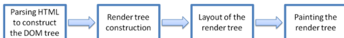
图2：渲染引擎基本流程
